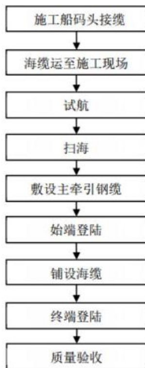
图 2.3-8 海缆敷设施工工艺
